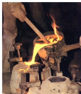
茶釜、鉄瓶などの鑄物製品は、1500度に熱して溶かした鉄を砂で作った型に流し込んで形を作ります。
